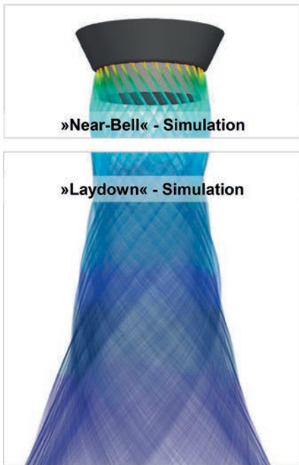
Bild 2 > Physikbasierende Simulation unterteilt in Near-Bell und Laydown-Simulation.
