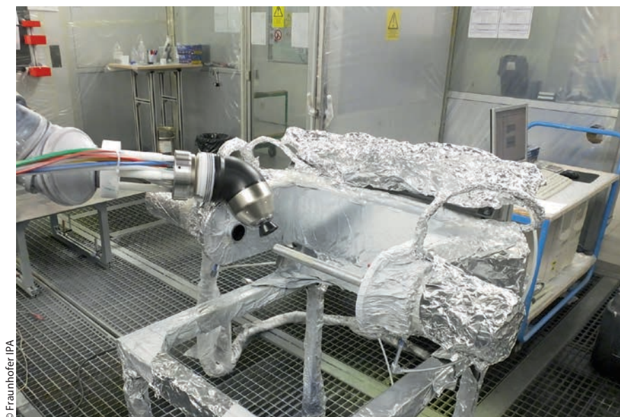
Bild 8 > Messung der Tröpfchengrößenverteilung mittels Laserbeugung.
