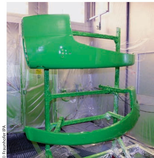
Bild 6 > Lackierung der Kotschützer zur Validierung.
